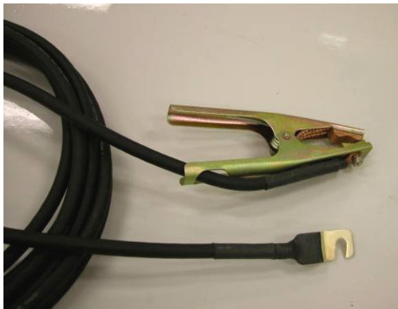
Figura 1-Cable para inyección de corriente
