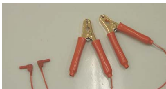
Figura 2-Cables para medición de tensión
